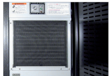
Frigo dedicato per refrigerazione del mandrino e delle viti a ricircolo di sfere
